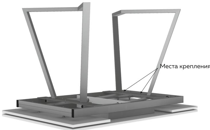
**4** При необходимости положение вставок относительно центральной столешницы отрегулировать с помощью 8-ми гаек находящихся под вставками.
