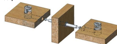
Схема установки эксцентриковой стяжки с двухсторонним штоком (рис.8)
