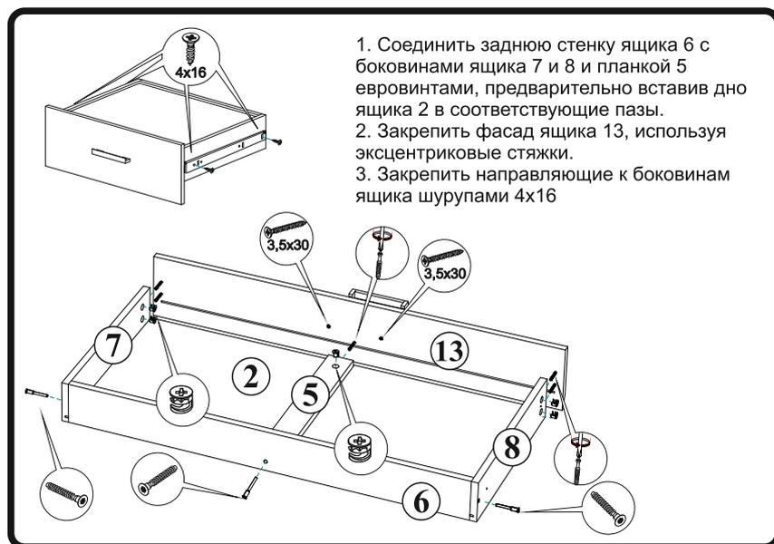
1. Соединить заднюю стенку ящика 6 с боковинами ящика 7 и 8 и планкой 5 евроинтами, предварительно вставив дно ящика 2 в соответствующие пазы.
