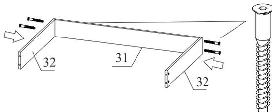
8.2. Закрепите деталь 36 к деталям 31 и 32 с помощью евровинтов 7x50.
