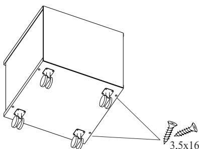
Установите опоры колесные с помощью шурупов 3,5x16.
