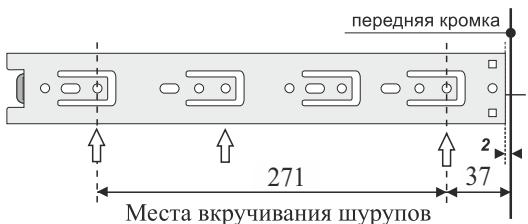
7.2. Вставьте эксцентрики в отверстия  $\phi 15 \times 13$  на деталях 11 и 12. Закрепите внутреннюю часть направляющих с помощью шурупов 3,5x16.
