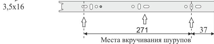
**ВНИМАНИЕ!** В зависимости от производителя направляющих места вкручивания шурупов могут отличаться. Необходимо выровнять направляющие по краю детали.
