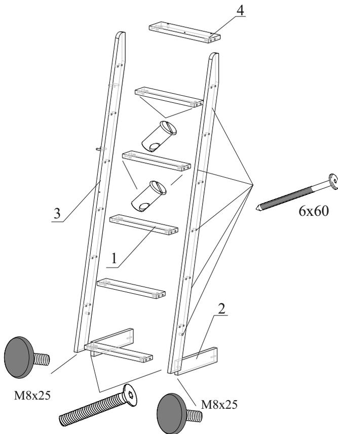
4.1. Установите в ступени (дет. 1 и 4) стяжки - бочонки и закрепите к деталям 3 с помощью винтов 6x60. Закрепите ножки.
