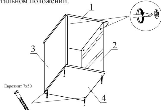
Закрепите деталь 4 к деталям 2 и 3, с помощью евровинта 7х50. Затем деталь 1 к 2 и 3, затяните эксцентрики.
