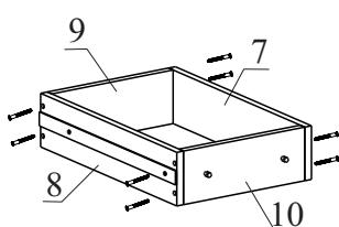
Закрепите детали 7,8,9 и 10 с помощью евровинтов 7х50
