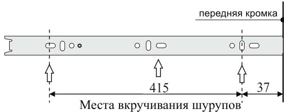
**ВНИМАНИЕ!** В зависимости от производителя направляющих места вкручивания шурупов могут отличаться. Необходимо выровнять направляющие по краю детали.
