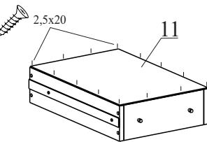
Выровняйте диагонали ящика, закрепите дно ящика ДВП на саморезы 2,5x20.
