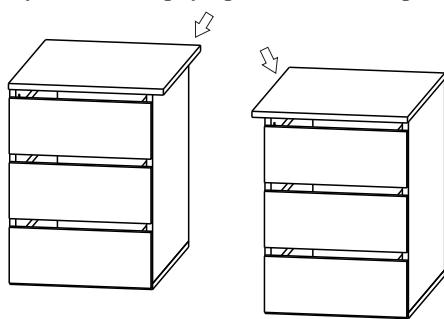
Перед установкой детали 1 необходимо определить нужное расположение крыши относительно корпуса, поворачивая деталь на 180 градусов.
