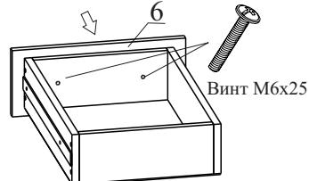
Закрепите к ящику фасад используя Винт М6х25.
