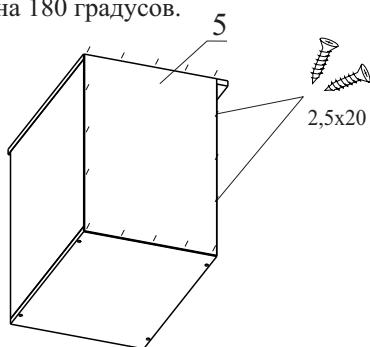
Выровняйте диагонали тумбы и закрепите деталь 5 с помощью саморезов 2,5x20.
