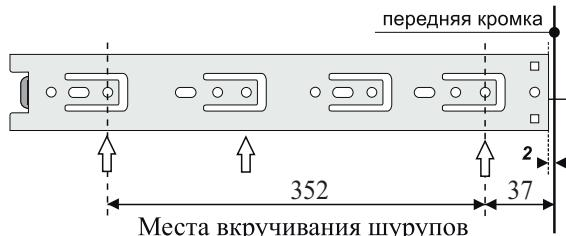
7.2. Закрепите внутреннюю часть направляющих с помощью саморезов 3,5x16 к деталям 7 и 8.
