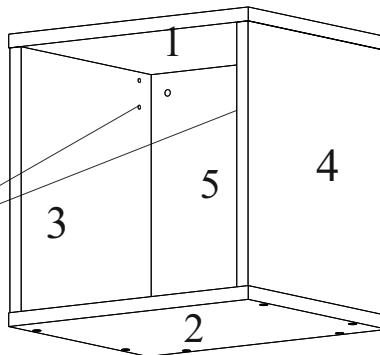
8.3. Установите дверь (дет. 6) с согласно схеме с помощью саморезов 4x16, отрегулируя петли так, чтобы между фасадом и корпусом остался зазор 2,5 мм.
