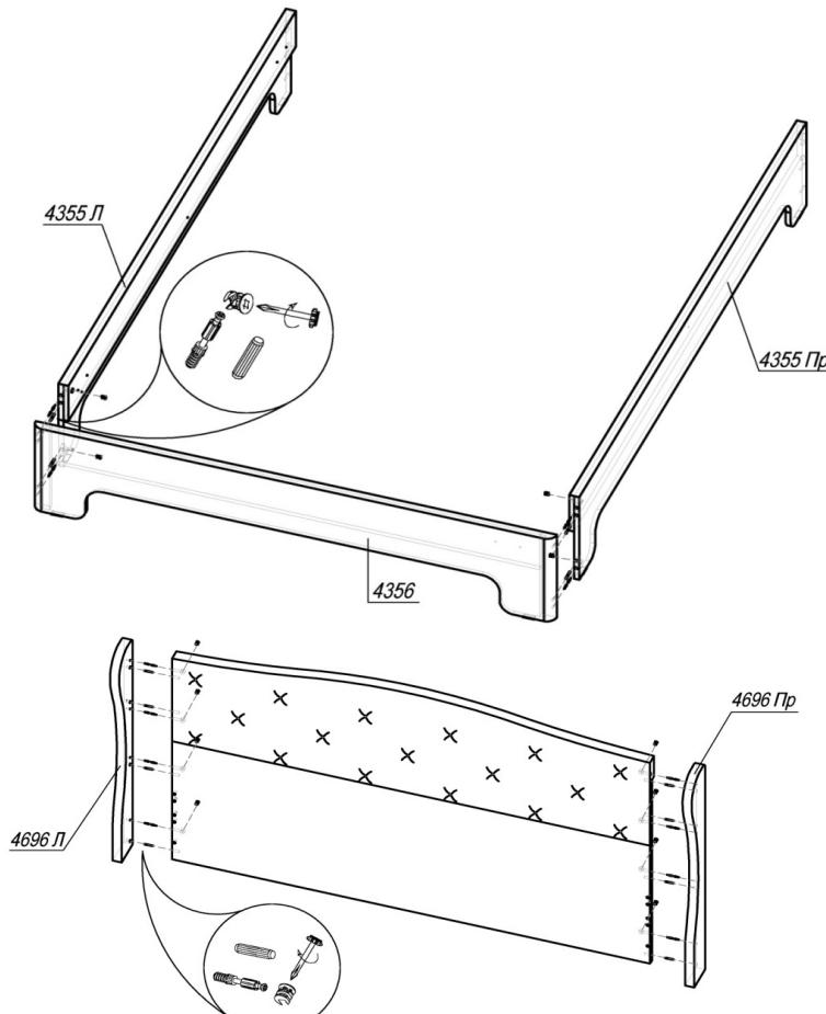
**ШАГ 1.** К бокам прибить подплатники гвоздями 2x20. Подготовить бок 4356 к сборке: вставить 4 штока эксцентрика (в отверстия Ø5 мм) и 4 шканта (в отверстия Ø8 мм). Соединить с боками 4355Л и 4355Пр, установить эксцентрик Minifix (по 2 шт в деталь) и закрепить шток эксцентрика. Вставить в бока 4696Л и 4696Пр по 4 штока эксцентрика (в отверстия Ø5 мм) и 4 шканта (в отверстия Ø8 мм), соединить с щитом. Установить эксцентрик Minifix (8 шт) и закрепить шток эксцентрика.
