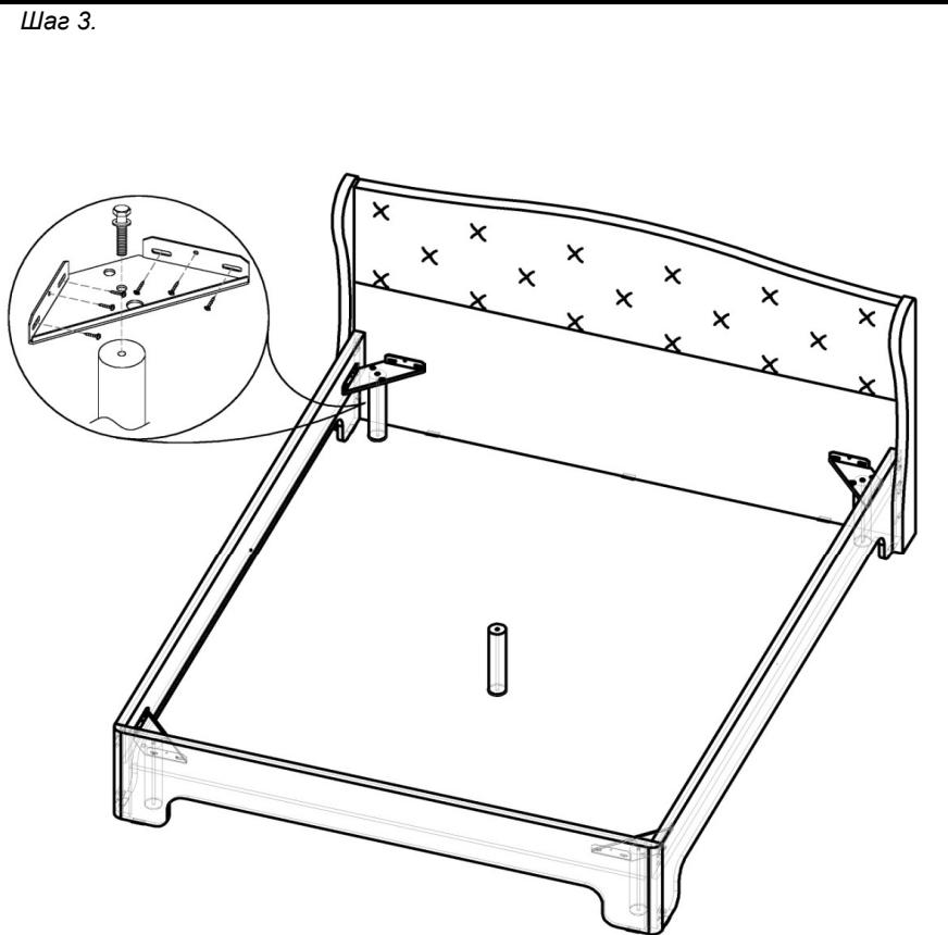
ШАГ 3. Стягнуть боки 4356, 4355Л, 4355 Пр и щит по углам стяжкой кроватной, используя саморезы с прессшайбой 4x16. Соединить стяжки кроватные с опорами посредством болтов.
