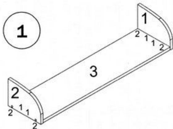
2. Соединить стенку заднюю (4) с деталями 1, 2, 3. Крепление стенки задней произвести при помощи евроинтов (2).
