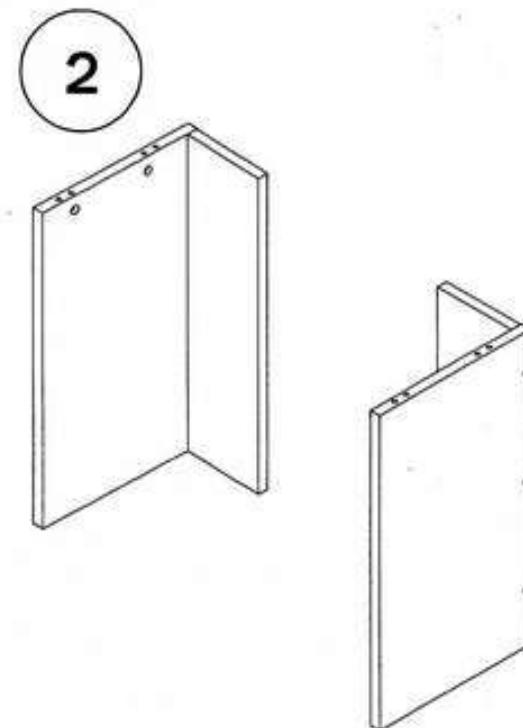
2. Собрать два комплекта СКЛ при помощи евровинтов 7\*70 мм
