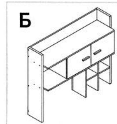
Разные виды исполнения достигаются путем поворота полок и других элементов конструкции , при этом боковины и царга свои места не меняют.
