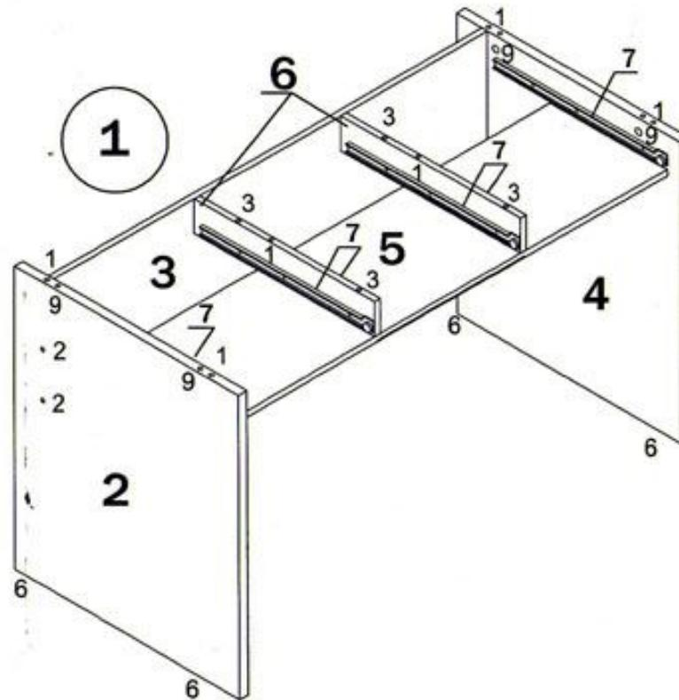
с деталями 3 и 4 при помощи евровинтов (2) и шкантов (1). Соединить стойки 5 с полкой 3 при помощи евровинтов (15)
