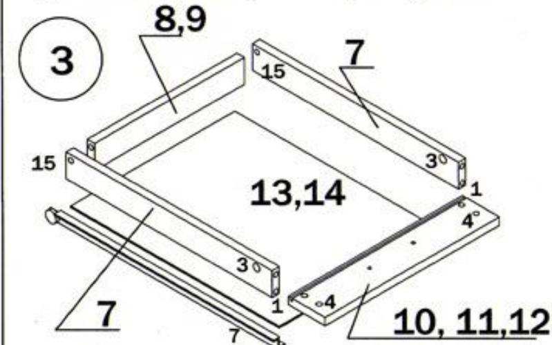
имеющейся на передних панелях 10, 11 и 12, вставить дно ящиков 13,14 до упора. Затем выровняв дно ящиков по периметру с боковинами 7 и задними стенками ящиков 8,9
