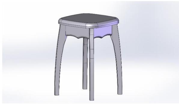
1. Положить сиденье с каркасом 1 на ровную поверхность, вставить ножки 5 на свои места, как показано на картинке. Поставить шайбы 3 на шпильки и наживить гайки 4.
