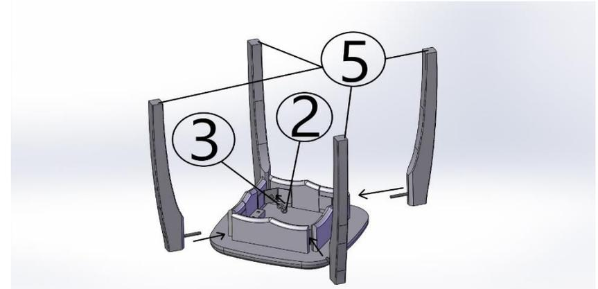
2. Перевернуть табурет сиденьем кверху, поставить табурет так, чтобы табурет стоял на ровной поверхности и касался всеми 4мя ножками поверхности. Далее нужно протянуть ключом 4 все гайки 2.
