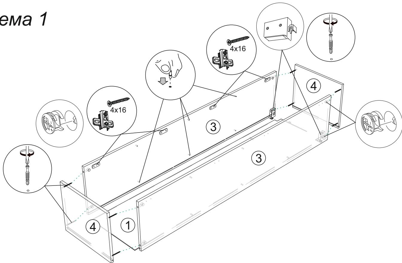
3. Переверните собранную конструкцию лицевой стороной вниз, уровняйте диагонали  $a=b$  и аккуратно не нарушая диагоналей закрепите заднюю стенку №1 к боковинам и крышкам с помощью уголков Rv8 и шурупов 4x16 как показано на схеме 2.
