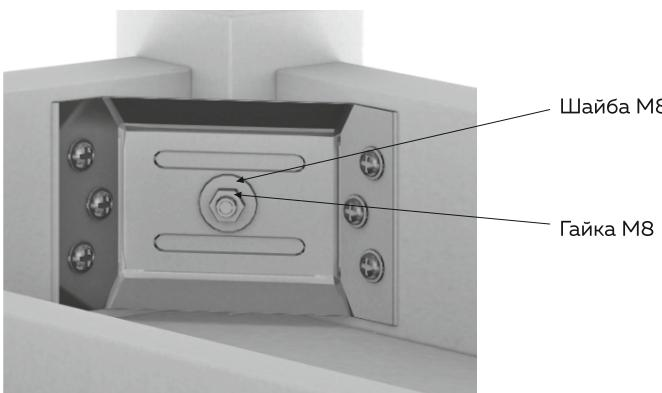
**4** С помощью шайбы M8 и Гайки M8 зафиксируйте ножку стола, используя ключ на 13
