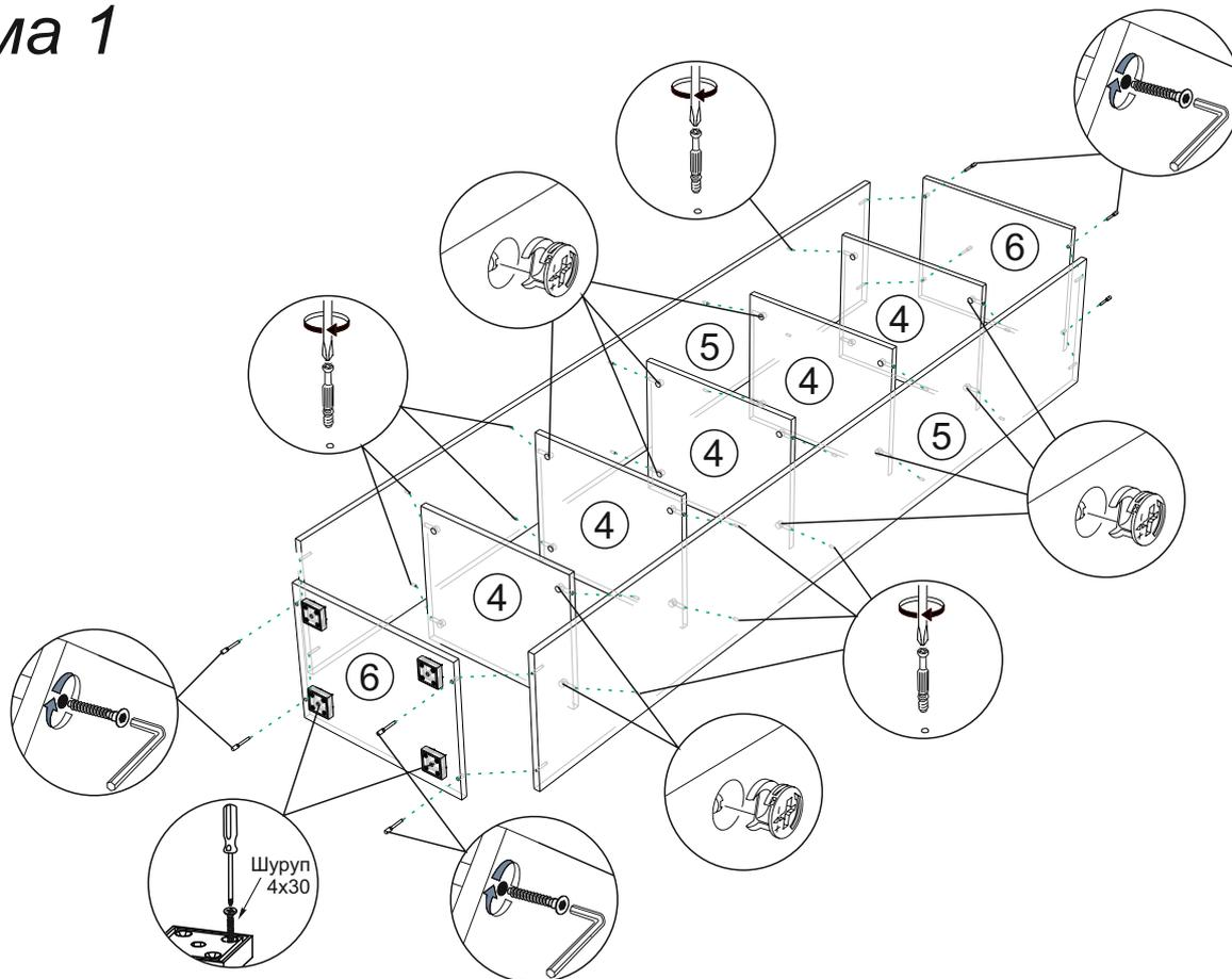
3. Чтобы установить задние стенки №1, №2, №3, необходимо собранную конструкцию перевернуть лицевой стороной вниз. Замерить, с помощью рулетки, и уровнять диагонали ( $a=b$ ). Наложите задние стенки и аккуратно, не нарушая диагоналей, прибейте ЛДВП гвоздями с шагом 130-150мм как показано на схеме 2.
