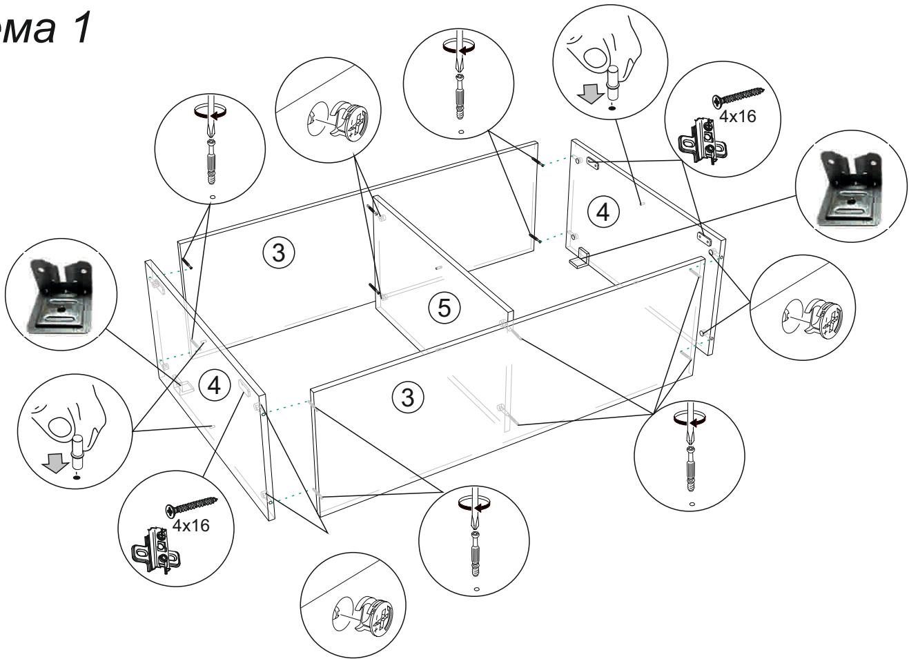
3. Чтобы установить задние стенки №1, необходимо собранную конструкцию перевернуть лицевой стороной вниз. Замерить, с помощью рулетки, и уравнять диагонали ( $a=b$ ). Наложите задние стенки, соедините профилем и аккуратно, не нарушая диагоналей, прибейте ЛДВП гвоздями с шагом 130-150мм как показано на схеме 2.
