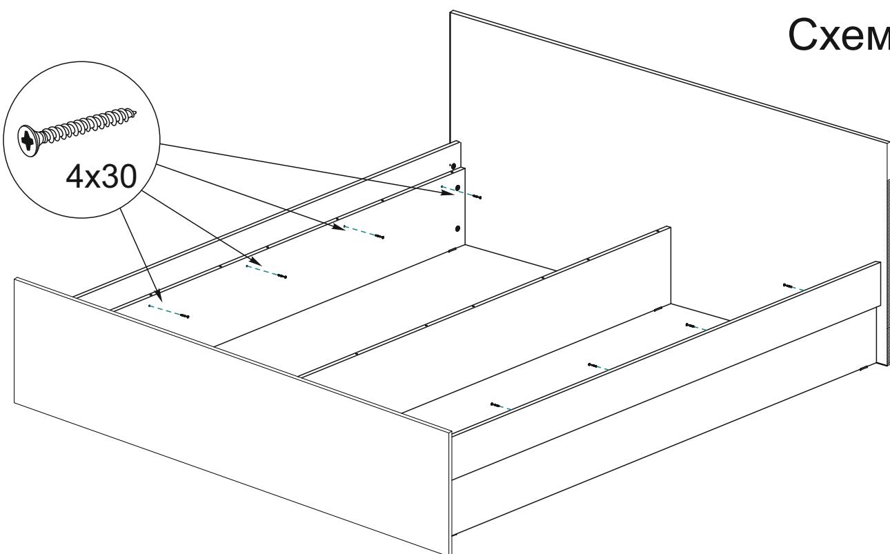
5. После сборки каркаса кровати, для придания конструкции жесткости, соедините между собой царги №5, № 6 и №7 с настилом №1 евровинтами, как показано на схеме 4.
