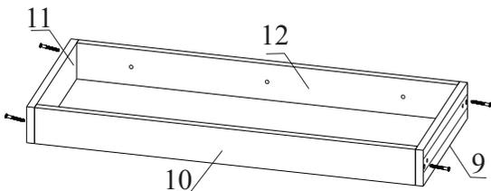
Закрепите детали 9,10,11 и 12 с помощью еврвинтов 7x50
