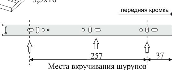
**ВНИМАНИЕ!** В зависимости от производителя направляющих места вкручивания шурупов могут отличаться. Необходимо выровнять направляющие по краю детали.
