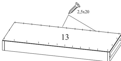
Выровняйте диагонали ящика, закрепите дно ящика ДВП на саморезы 2,5x20.
