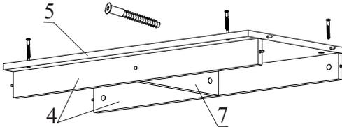
Закрепите детали 4, 7 к детали 5 с помощью евровинта 7х50. Затем затяните эксцентрики.
