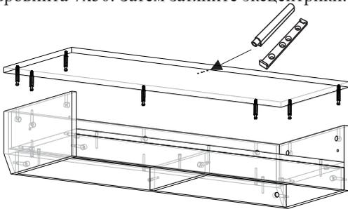
К крыше паз. №1 прикрутите эксцентрики закрепите Push to open, затяните эксцентрики.
