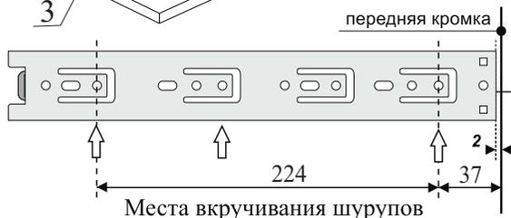
Закрепите внутреннюю часть направляющих с помощью саморезов 3,5x16 к деталям 9 и 11.
