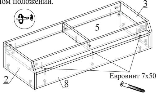
Закрепите детали 8, 3, 2, затяните эксцентрики и евровинты 7х50.
