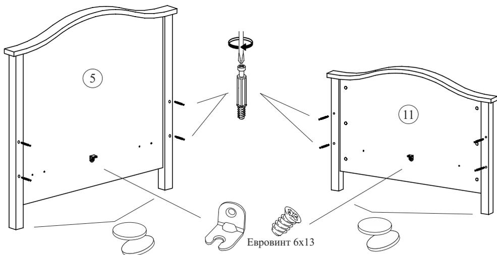
7.2. Закрепите на деталях 9 и 10 стяжки угловые с помощью евровинта 6x13, вставьте эксцентрики в отверстия  $\phi 15 \times 13$ .
