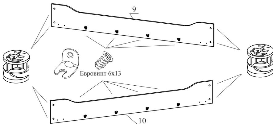
**8. Сборка кровати. ВНИМАНИЕ!** При сборке избегать неосторожных ударов и излишних усилий. Сборку производить в горизонтальном положении.
