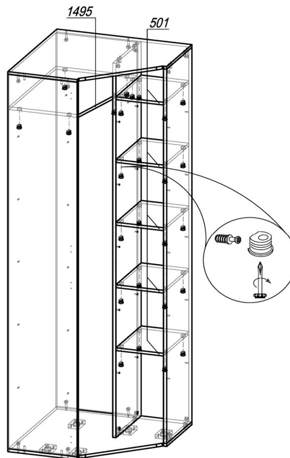
ШАГ 2. В полки 1495 и 501 установить стяжку-полкодержатель (по 4 шт в деталь), вставить полки в шкаф и закрепить дюбели, затянув стяжки.
