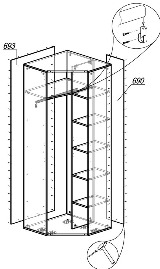
ШАГ 3. Проверив рулеткой или рейкой равенство диагоналей, прибить гвоздями 2x20 задние стенки ЛДВП 690 и 693. Установить шкаф на место. Шурупами 4x16 привернуть штангодержатели, поставить штангу.
