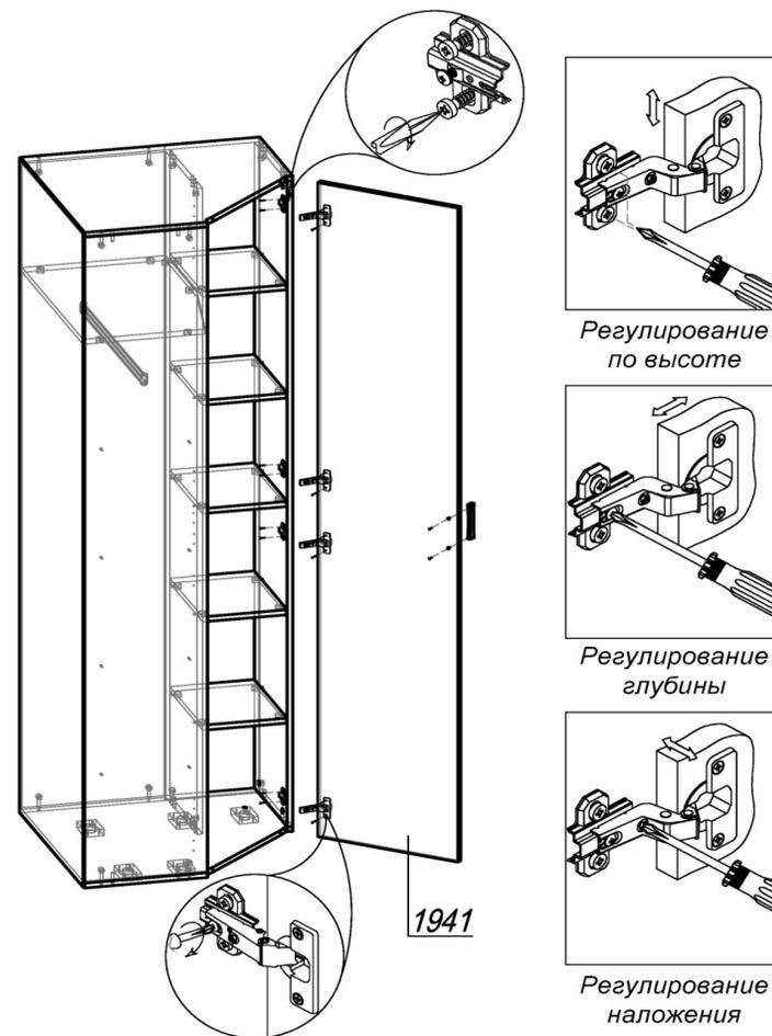
ШАГ 4. Разобрать петлю для накладной двери на две части (петля и ответная планка петли). Закрепить первую часть петли шурупами 4x16 на створке 1941. Вторую часть петли (ответная планка) прикрепить шурупами 4x16 к боку 1013. Навесить створку на накладные петли. Досверлить отверстия  $\varnothing 5$  мм в створке и привернуть ручку шурупами 4x30. Закрыть эксцентрики и открытые отверстия соответствующими заглушками.
