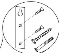
Привернуть к щиту 1955 3 плоских навеса с помощью шурупов 4x16. Навесить конструкцию на дюбель-гвозди, вмонтированные в стену.
