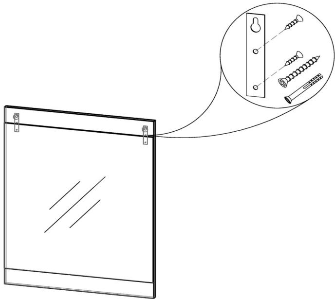
Привернуть к щиту 1954 2 плоских навеса с помощью шурупов 4x16. Навесить конструкцию на дюбель-гвозди, вмонтированные в стену.
