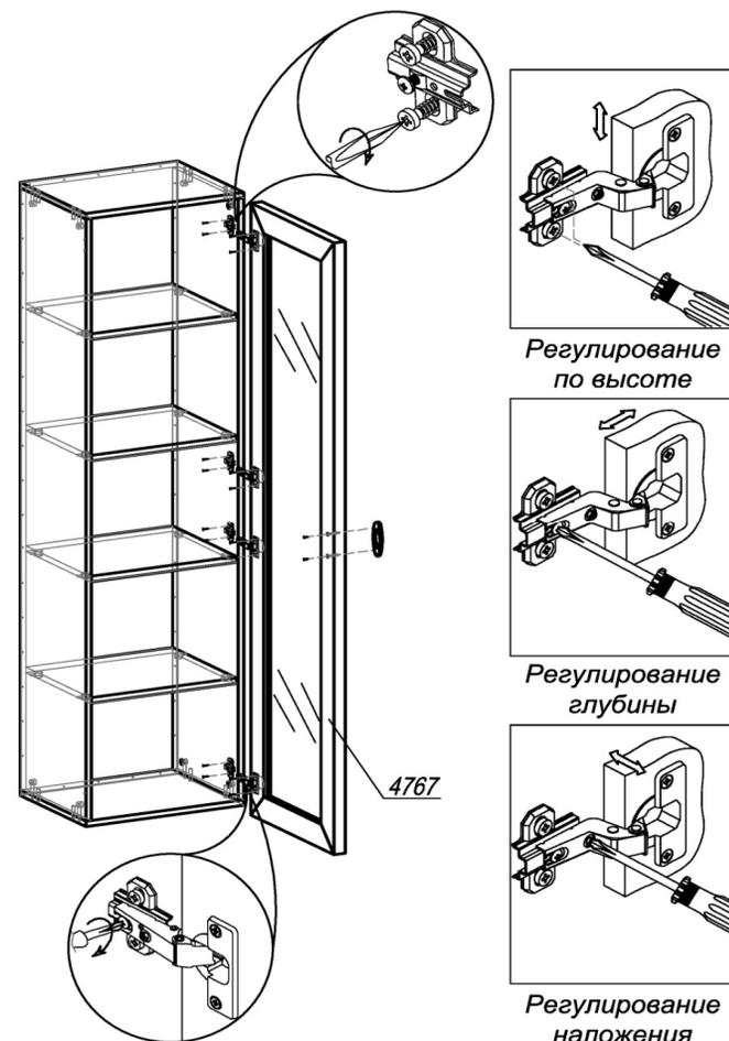
ШАГ 4. Разобрать петлю для накладной двери на две части (петля и ответная планка петли). Закрепить первую часть петли шурупами 4х16 на створке 4767. Вторую часть петли (ответная планка) прикрепить шурупами 4х16 к боку 4642. Навесить створку на накладные петли. Привернуть ручку винтами. Закрыть эксцентрики заглушками. Убедитесь, что шкаф стоит ровно.
