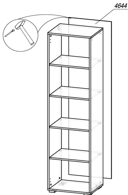
ШАГ 3. Сборка производится лицевой стороной вниз. Проверив рулеткой или рейкой равенство диагоналей, прибить гвоздями 2х20 заднюю стенку ЛДВП 4644. Поднять шкаф и установить его на место.
