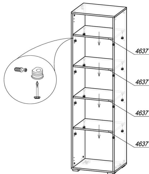
ШАГ 2. В полки 4637 установить стяжку-полкодержатель (по 4 шт в деталь), вставить полки в шкаф и закрепить дюбели, затянуть стяжки.
