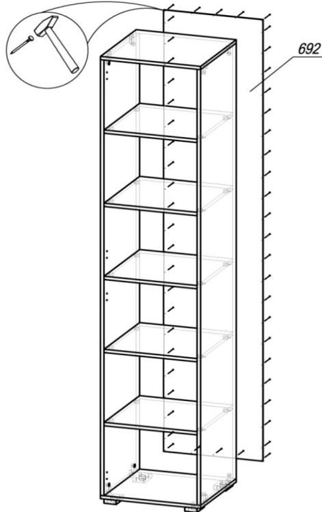
**ШАГ 3.** Сборка производится лицевой стороной вниз. Проверив рулеткой или рейкой равенство диагоналей, прибить гвоздями 2х20 заднюю стенку ЛДВП 692. Поднять шкаф и установить его на место.
