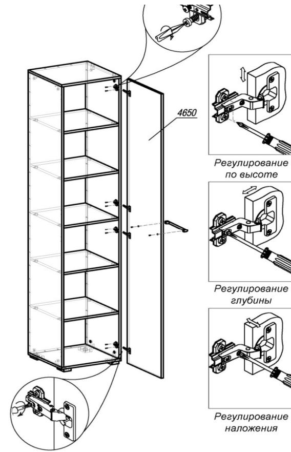
**ШАГ 4.** Разобрать петлю для накладной двери на две части (петля и ответная планка петли). Вторую часть петли (ответная планка) прикрепить шурупами 4х16 к боку 1042Л (1042Пр). Подготовить створку 4650, закрепив первую часть петли шурупами. Навесить створку 4650 на накладные петли. Привернуть ручку винтами 4х25. Закрыть эксцентрики защелками. Убедитесь, что шкаф стоит ровно. При необходимости выровняйте его с помощью регулировки опоры.
