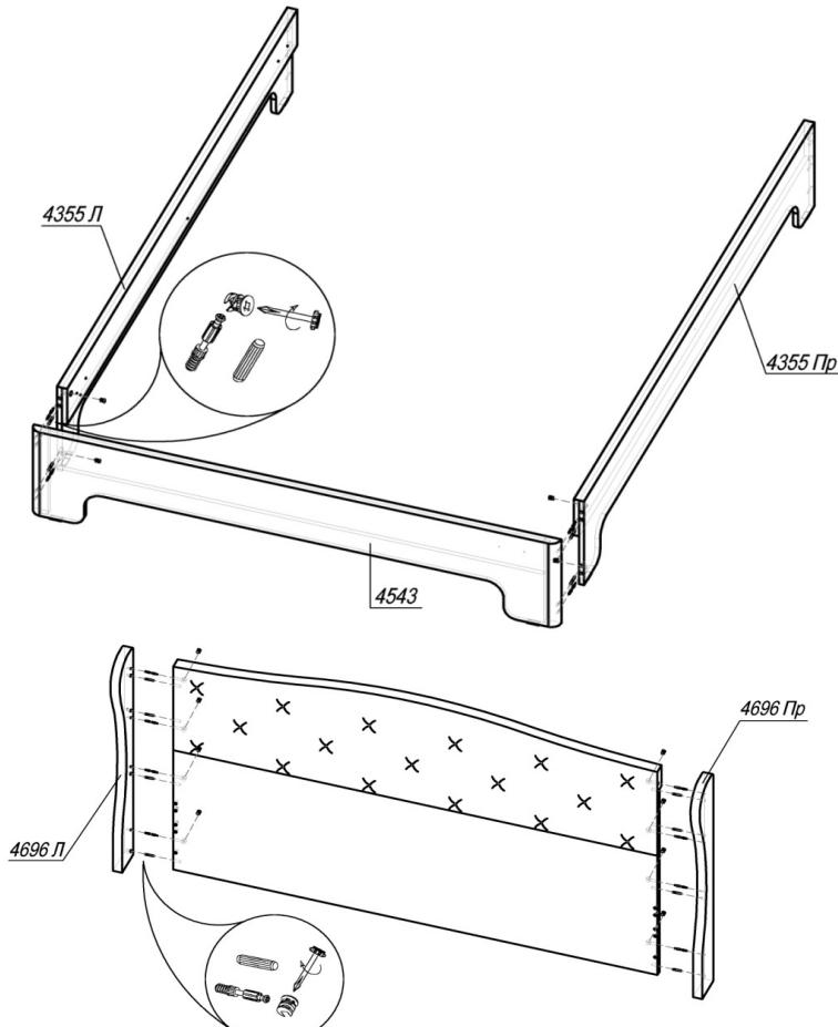
**ШАГ 1.** К бокам прибить подпятыники гвоздями 2x20. Подготовить бок 4543 к сборке: вставить 4 штока эксцентрика (в отверстия Ø5 мм) и 4 шканта (в отверстия Ø8 мм). Соединить с боками 4355Л и 4355Пр, установить эксцентрик Minifix (по 2 шт в деталь) и закрепить шток эксцентрика. Вставить в бока 4696Л и 4696Пр по 4 штока эксцентрика (в отверстия Ø5 мм) и 4 шканта (в отверстия Ø8 мм), соединить с щитом. Установить эксцентрик Minifix (8 шт) и закрепить шток эксцентрика.
