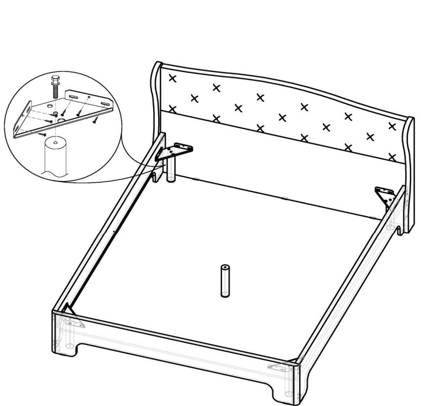
ШАГ 3. Стягнуть бока 4543, 4355Пр и щит по углам стяжкой кроватной, используя саморезы с прессшайбой 4x16. Соединить стяжки кроватные с опорами посредством болтов.
