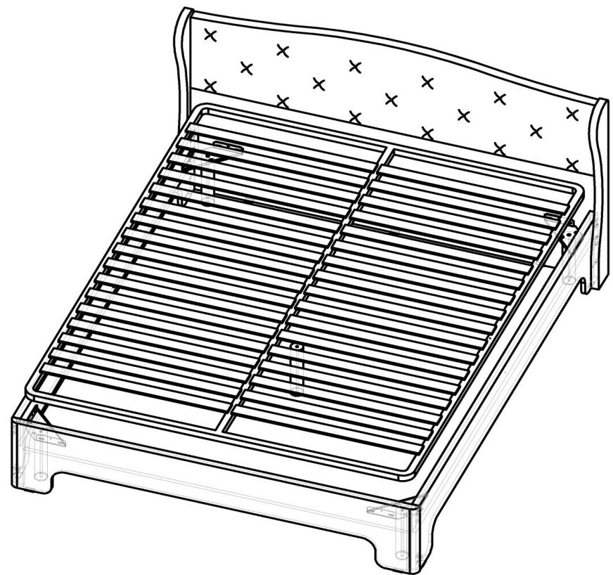
ШАГ 4. Положить ортопедическую решетку на стяжки кроватные и соединить болтом с опорой. При необходимости отрегулировать опору по высоте.
