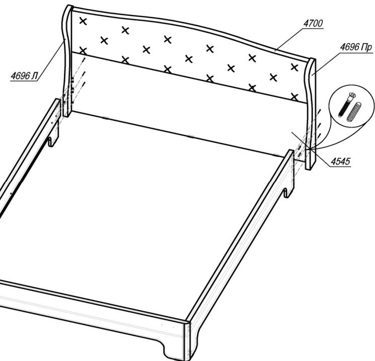
ШАГ 2. К щиту прибить подпятники гвоздями 2x20. Вставить в бока 4355Л и 4355Пр по 2 шканта (в отверстия Ø8 мм). Соединить с щитом, зафиксировать с помощью 6 евровинтов.
