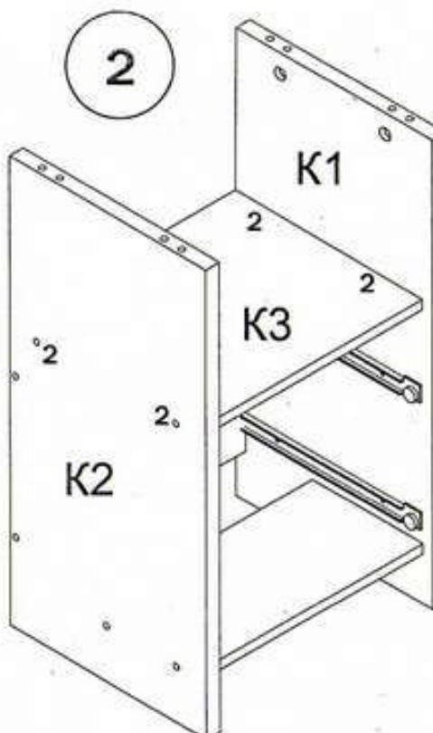
3. Закрутить в муфты полки Стол 1 дюбеля-стяжек растекс (4). Забить шканты (1) в боковины K1 и K2. Соединить полку Стол с каркасом тумбы (детали K1 и K2). Фиксацию стяжек-растекс произвести путем поворота их по часовой стрелке.
