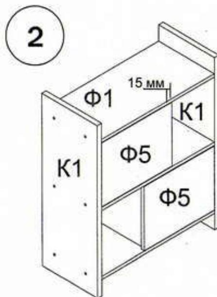
Для удобства открывания двери используется выступ двери относительно стойки 15 мм. При необходимости имеется возможность регулировки положения двери при помощи петель (3). Поставить декоративные заглушки (5) в местах установки евроинтов (2).
