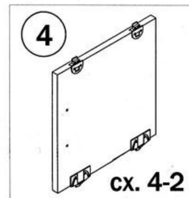
.Вставить фасад 12 так, чтобы ролики (15) расположенные на фасаде 12 вошли в пазы на деталях 6, 7.
