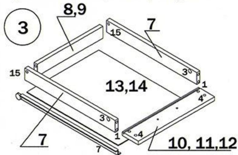
имеющейся на передних панелях 10, 11 и 12, вставить дно ящиков 13, 14 до упора. Затем выровнять дно ящиков по периметру с боковинами 7 и задними стенками ящиков 8,9
