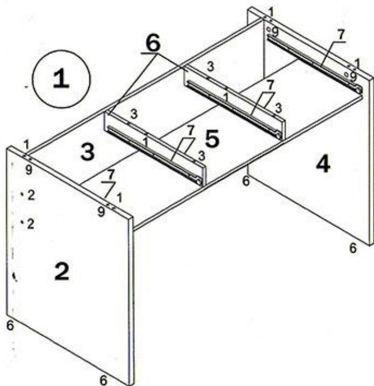
с деталями 3 и 4 при помощи евроинтов (2) и шкантов (1). Соединить стойки 5 с полкой 3 при помощи евроинтов (15)
