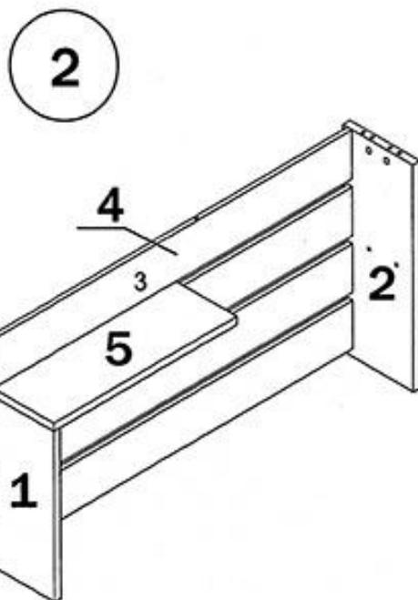
Забить шкант (1) в планку 4 и соединить ее с боковиной 2 при помощи евроинта (2) и полкой 5 при помощи стяжки-растекс (3). Стяжка-растекс (4) должна располагаться с тыльной стороны детали 4.
