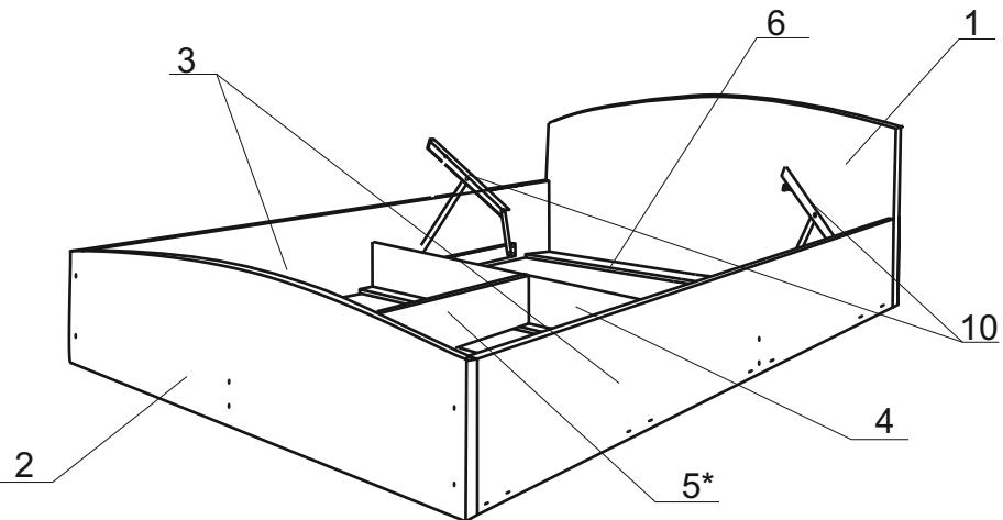
Крепить к царгам кровати (дет.3) поперечные упоры шириной 8см (дет 6) с помощью конфирматов 7х50 (Ф-№1). Внутрь кровати кладем дно (дет. 7) без ручки (в нишу с подъемным механизмом), затем крепим ребро жесткости (дет 4) с помощью конфирматов (Ф-№1) и ключа (Ф-№10).
