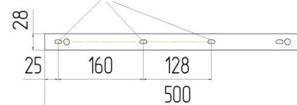
На верхний торец ребра (ребер) жесткости прибиваем пластиковые подпятники (Ф-№7) с помощью гвоздей (Ф-№12) в местах соприкосновения ребер с металлической решеткой.
