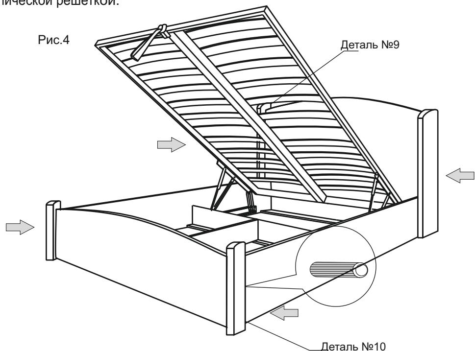
Затем к спинкам (дет.№2,3) при помощи шкантов (Ф-№4) с kleem (Ф-№5), не допуская зазора, присоединить декоративные накладки (дет.11,12) (см. рис.4), выдержать 24 чаа, не прилагая механических усилий.
