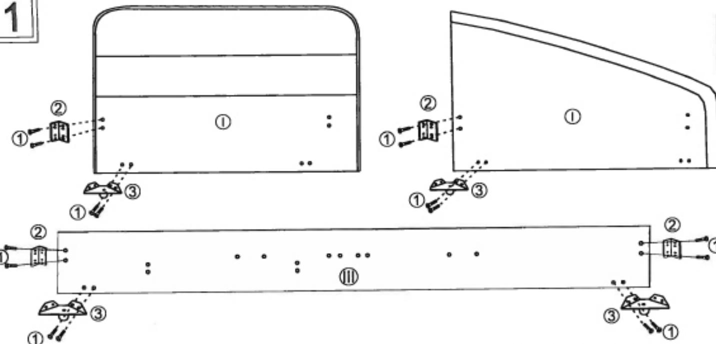
К нижней царге кронштейн крепится на один винт M6x20 и саморез 4x20
