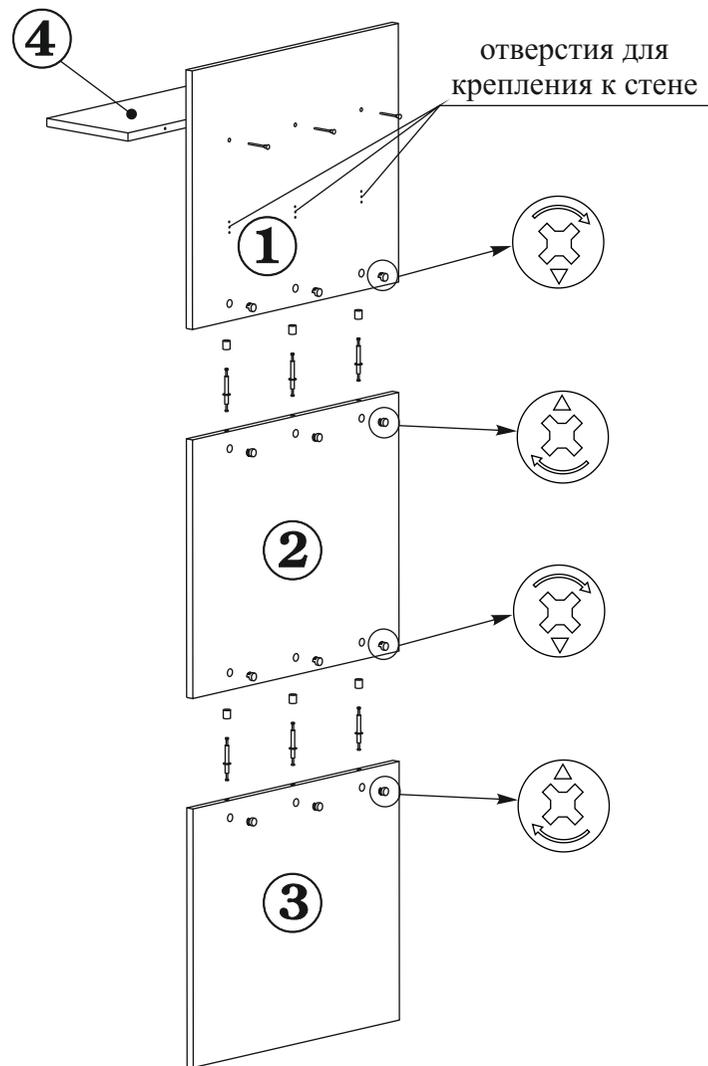
1. В отверстия на вертикальных панелях (дет.№№1,2,3) вставьте эксцентрики. **Обратите внимание: стрелка на эксцентрике должна быть направлена к торцу детали.**
