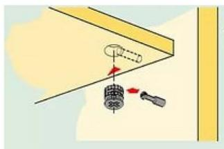
Схема установки направляющей
